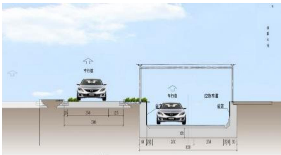
图2-6 怡海大道北延U型槽段断面
