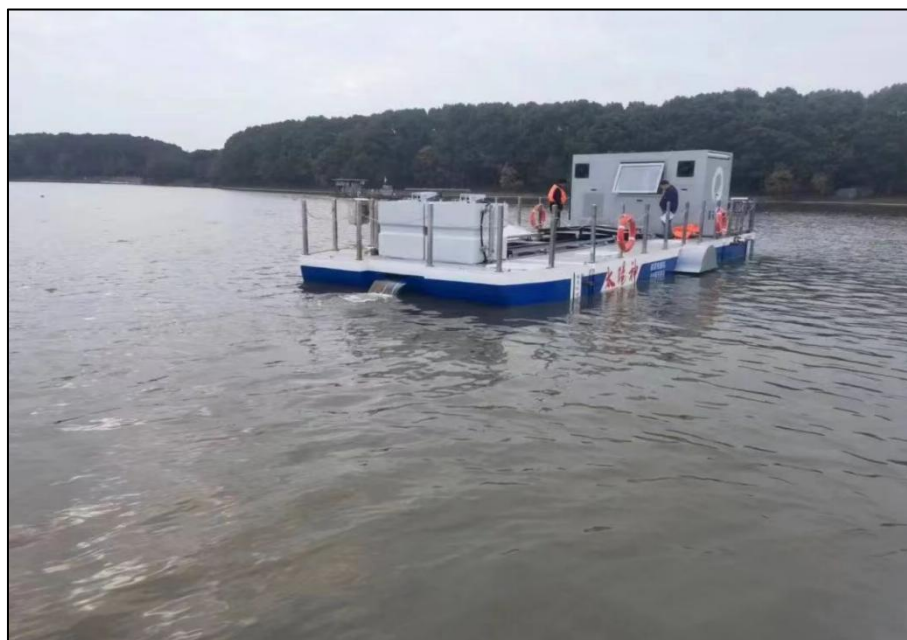
图 2.8-3 组合式底泥洗脱船
